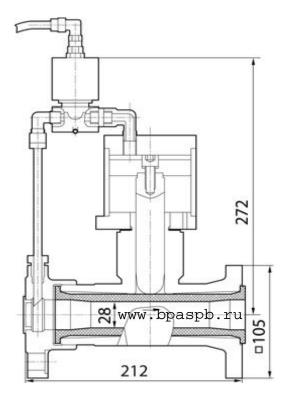
Быстродействующее автоматическое устройство аварийного закрытия трубопровода предназначено для оперативного отключения подачи воды на контролируемых участках трубопровода. Устройство работает от дистанционного управления и перекрывает трубопровод по электрическому управляющему сигналу. Напряжение питания - 220В.
